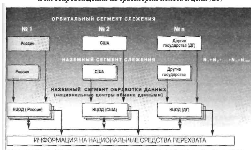
Наземно-орбитальный сегмент слежения за пусками ракет и их сопровождения на траектории полета к цели [21]
